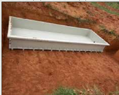
Figura 18 - Tanque de polipropileno de 8mm (espessura da chapa)
