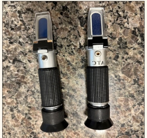
A esquerda refratômetro óptico de Brix e a direita refratômetro óptico de proteína
