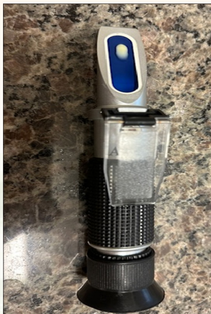
Refratômetro com uma gota de colostro para mensuração de Brix
