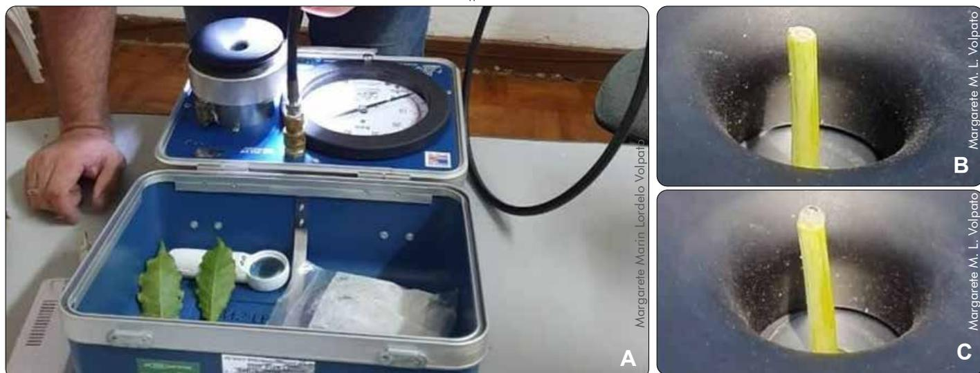
Nota: A - Bomba de pressão tipo Scholander para medir potencial hídrico; B - Folha com pecíolo na parte externa sem pressão; C - Folha com pecíolo na parte externa com pressão.
