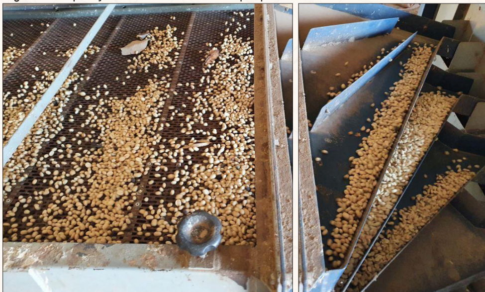
Figura 5 - Separação das sementes de café por peneira e densidade
