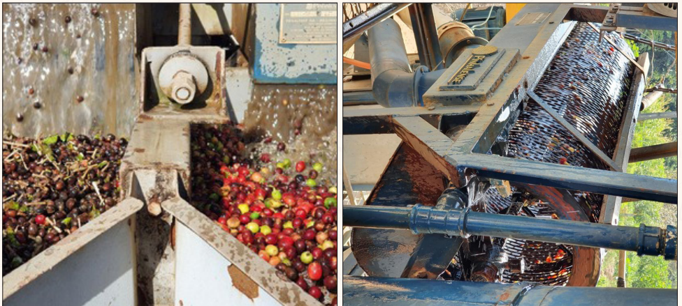
Figura 2 - Sistema mecânico para lavagem e separação hidráulica de frutos de café cereja e verde da porção boia
