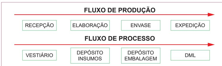
Para isso, o processo começa com a recepção e o desengace da uva (considerada uma área suja), em seguida, o mosto (vinho pré-fermentação alcoólica) é encaminhado para a sala de elaboração. Depois, o vinho é levado à sala de envase, passando pelas barricas ou não. As garrafas vazias devem entrar para o envase, somente após serem lavadas. No caso do espumante, o vinho passa primeiro na sala de envase, vai para a sala de pupitres e depois volta para o envase.
