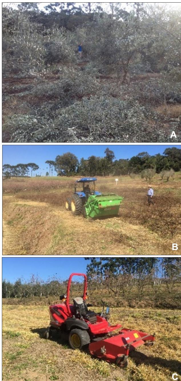
Nota: A - Restos da poda; B - Trincha acoplada ao trator; C - Triturador automotriz.
